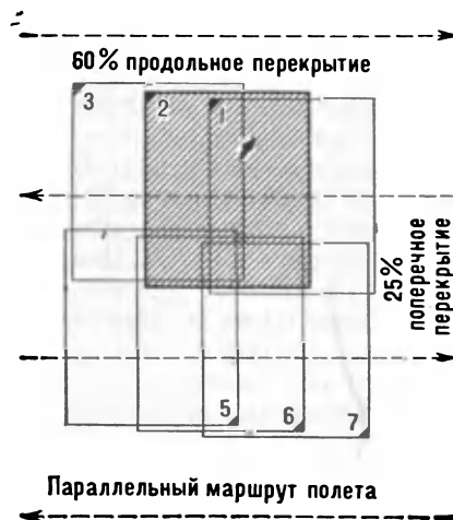
Рис. 2-19. Схема аэрофотосъемки. Аэроснимки, используемые для стереоскопического анализа фотографируемой территории, обладают продольным и поперечным перекрытиями. Это достигается таким способом съемки, при котором маршрут полета как бы повторяет путь машины для стрижки газонов.
